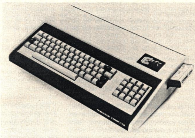
Bild 1. Die ROM-Kassetten beinhalten bis zu 16 KByte und werden seitlich in den „Sorcerer“ eingeschoben
